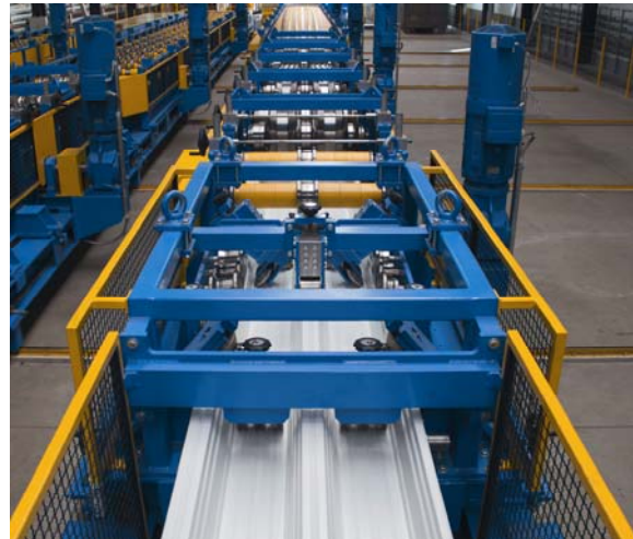
Bild 1: Profiliervorgang am Beispiel eines Trapezprofils
